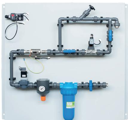
Grupo de regulación agua filtro, reductor de presión, manómetro, electroválvula de interceptación, válvula motorizada de regulación flujo, medidor electrónico de capacidad y válvula de regulación manual.
