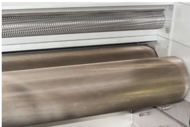
Рис. 1. Вальцы с титановым покрытием
