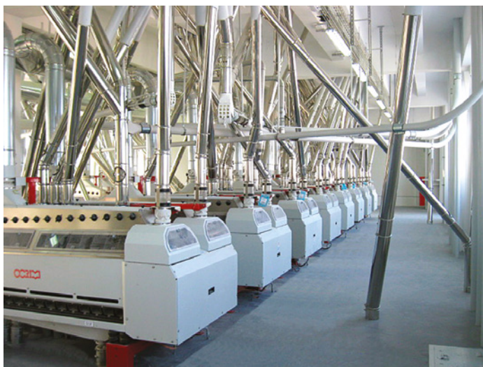
Balashov (Russia) - piano semolatrici del primo impianto realizzato da Ocrim per Makprom.
